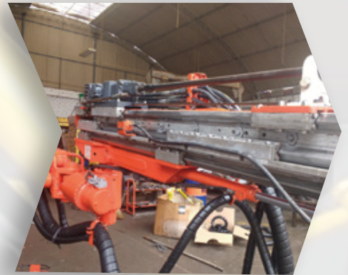
Overhaul de equipo de perforación (JUMBO FRONTONERO).
